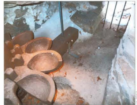
Handgeschnitztes Löffelrad, Aufhebelbalken, Zugstange und Ablauf
