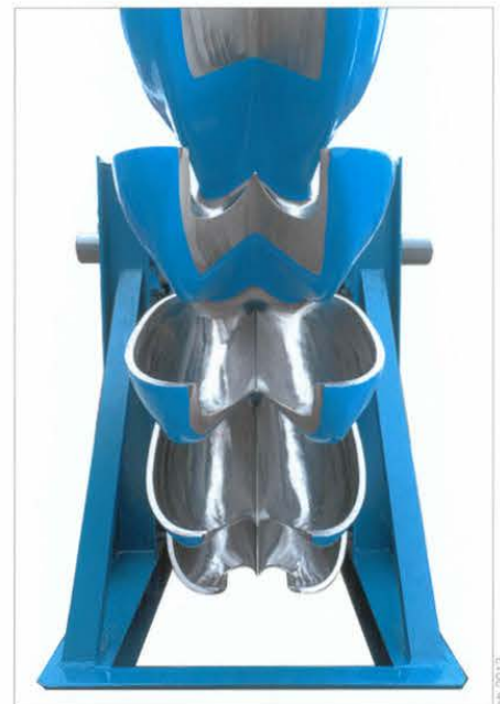
Die Weiterentwicklung des Löffelrades: Eine Pelton-turbine aus Chrom-Nickel-Stahl und einem Gewicht von 17 Tonnen. Für eine Wassermenge von 5,12 m 3 /s, Drehzahl 428,6 U/min, Gefälle 1016 m für das Kraftwerk Mattmark, Zentrale Stalden (Wallis). Hersteller ist die Andritz Hydro AG. Sie ist die Nachfolgerin der Maschinenfabrik Bell in Kriens (Luzern) deren Tätigkeit vor über 150 Jahren begann. L.A. Pelton unterteilte im Jahre 1880 die Halbkugeln in zwei durch eine Mittelscheide getrennte Hälften. Dadurch wird der Wasserstrahl seitlich weggeführt, was den Wirkungsgrad fast verdoppelt
