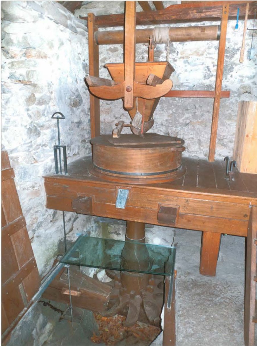
Inneres der Mühle Calonico aus Eichen- und Lärchenholz. Die verschieb- und begehbare Glasplatte dient der Sicherheit. Eine Eigenart der Tessiner Mühlen besteht darin, dass der Schüttrichter, in der Höhe verstellbar, aufgehängt ist. Die darunter angebrachte U-förmige vibrierende Schüttrinne kann durch einen Schnurzug in ihrer Schräge eingestellt werden, damit das Mahlgut regelmässig zwischen die Mahlsteine rieselt. Die Vibration der Schüttrinne wird durch den Hebel, der über die rauhe Oberfläche des sich drehenden Steins gleitet, erzeugt
